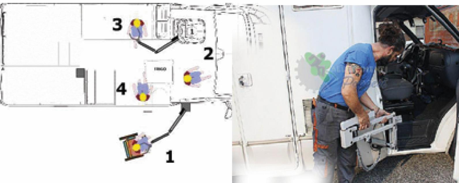
La possibilità di sfilare la gruetta dalla staffa permette di avere lo strumento operativo nei punti critici del camper o caravan, mediante installazioni di staffe posizionate artigianalmente nel mezzo
