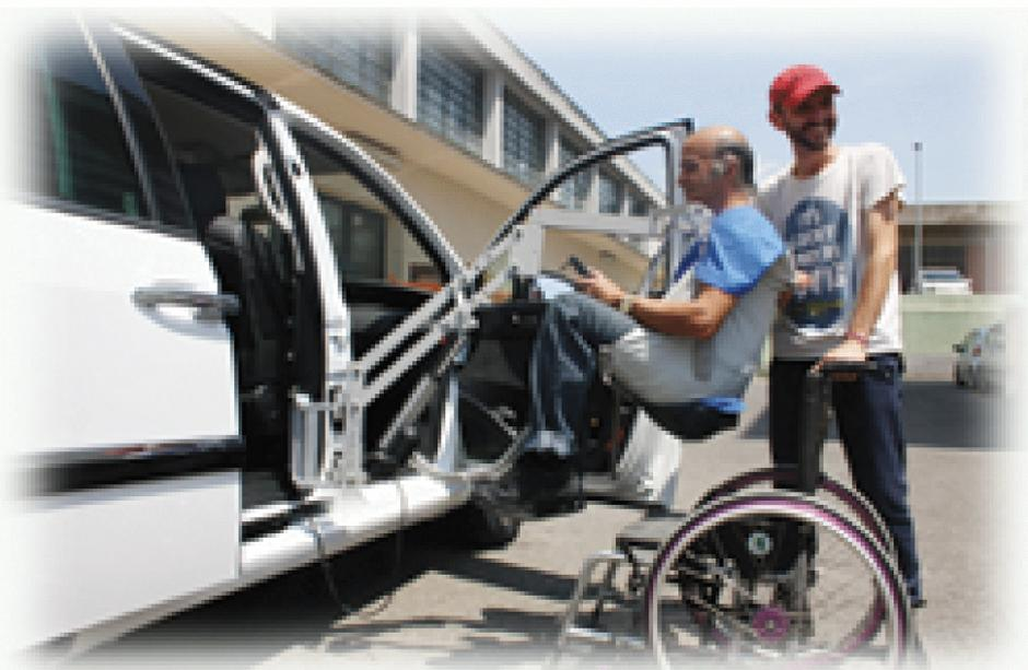
L'installazione della cerniera sul montante del veicolo con porta scorrevole permette l'accesso del disabile con gruetta sia anteriormente accanto all'autista. Sia Posteriormente nella fila centrale.
